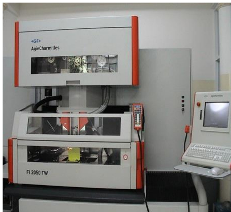
Hình 3.8 Máy cắt dây siêu chính xác FI2050TW của Công ty TNHH Lập Phúc
