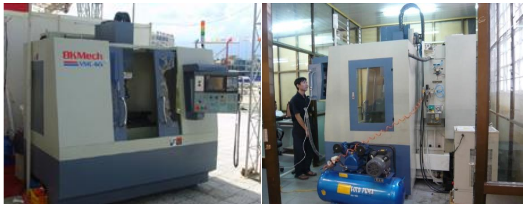
Hình 3.2 Máy phay CNC 5 trục của BKMECH
