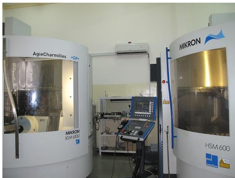
Hình 3.6 Trung tâm gia công cao tốc Mikron XSM600U (5 trục) và HSM600 của Công ty TNHH Lập Phúc
