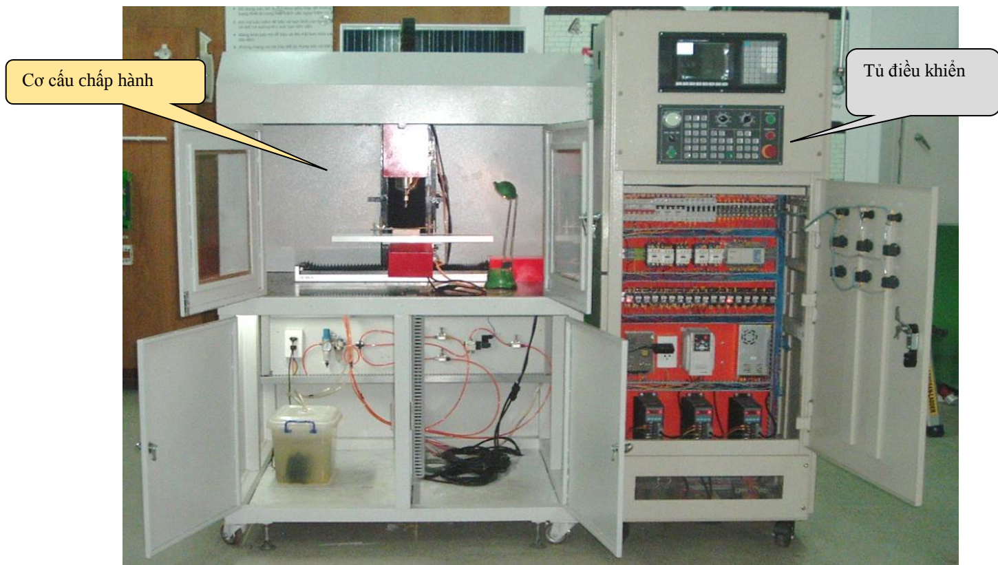
Hình 5.10. Mô hình máy phay CNC
