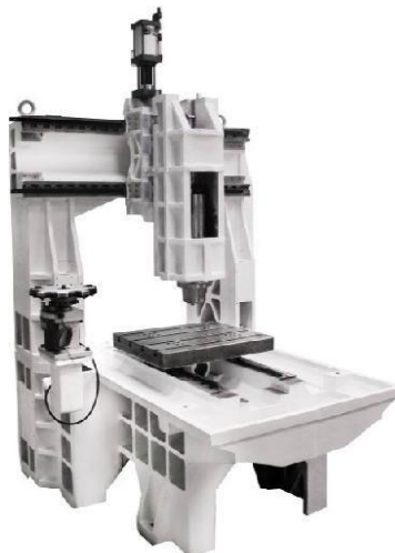
Hình 3.4 Kết cấu máy phay CNC cao tốc
